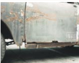
ドア、フェンダーの下部などは腐食して穴があいている
