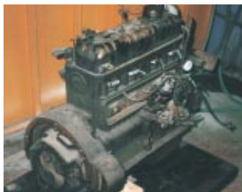
エンジンを降ろし、完全オーバーホールを実施
