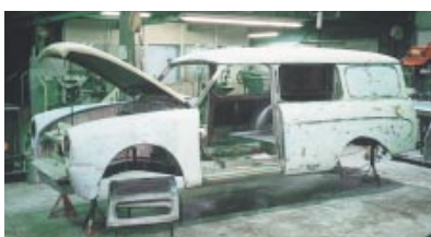
傷みの激しかったボデーもようやく塗装前の状態に仕上がる
