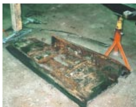
床面の右の腐食部分はこのような切断
