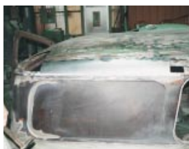
鋼板から成形したパーツを溶接
