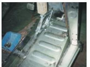
成形した部品を切断した個所に溶接貼り付け
