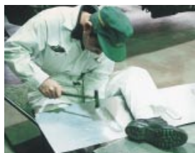
切断部分は手作業による板金で成形
