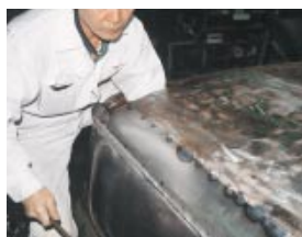
溶接貼り継ぎした部分を調整
