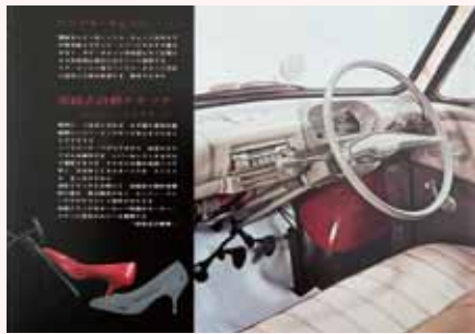
【カタログ抜粋】シンコー・ヒノマチックで2ペダルによる運転が可能。また、RRでコラムシフト採用に成功した数少ないクルマであることを示す。
