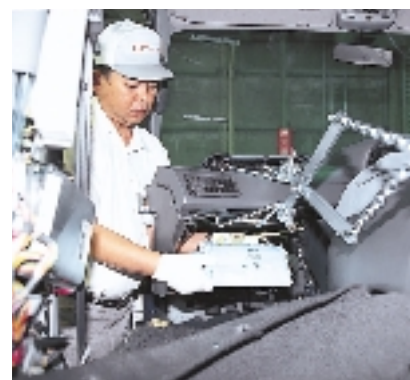
エアバッグインフレーターを取り外し検討状況
