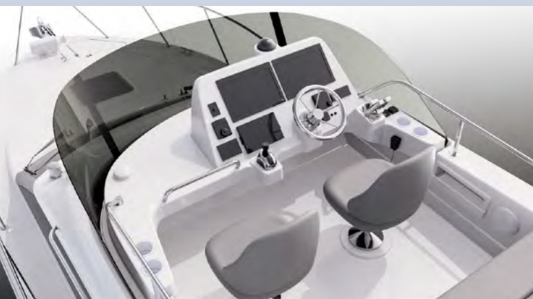
フライブリッジのコンソールは最大16インチディスプレイを2枚装備できる。また、足元との干渉が改善されたことで、より自然な姿勢で操船できるレイアウトとなっている。
