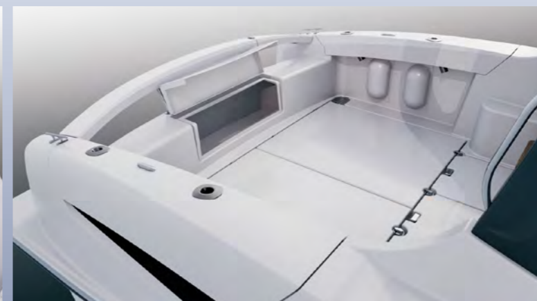
アフトデッキにはフェンダーやカバーを収められる収納が追加され、係留準備や乗下船時の煩雑さを抑えつつ、デッキ全体をすっきりと整えられる構成に仕上げられている。
