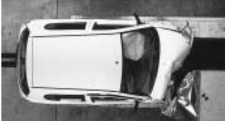
GOAは、「衝撃吸収ボディ」と「高強度キャビン」があいまって乗員の生存空間を確保し、同一排気量クラスで世界トップレベルの乗員保護性能を追求した衝突安全ボディです。このGOAは1995年12月、当時トヨタのラインアップでは最も小さなスターレットから採用を開始し、現在までにはほぼ全ての乗用車(含むRV)に展開を済ませました。そして、クラス世界トップレベルを維持するために試験条件・性能目標を常に進化させています。例えば、実車衝突実験では55km/hのフルラップ前面衝突、64km/hでのオフセット前面衝突、55km/hでの側面衝突とそれぞれ速度を高め、より厳しい試験条件のもとでGOAの進化を達成しています。
