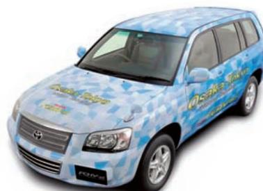
自社開発の高性能燃料電池「トヨタFCスタック」を搭載しているほか、プリウスで培ったハイブリッド技術を応用した高効率でクリーンなエコカーです。ルーフ・フェンダー等のアルミ化による軽量化、優れた空力性能、フロンフリーエアコンの採用など、多面的にエコを追求しています。
