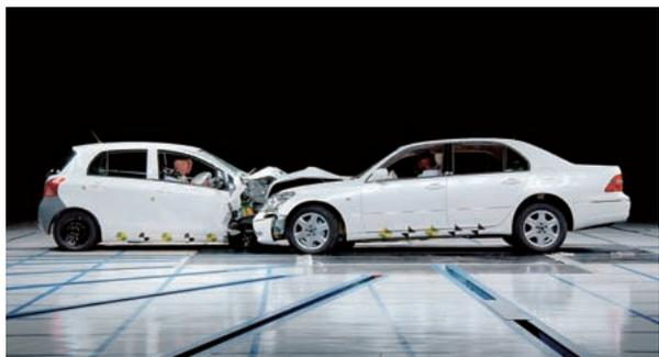
GOA は、「衝撃吸収ボディ」と「高強度キャビン」があいまって乗員の生存空間を確保し、同一排気量クラスで世界トップレベルの乗員保護性能を追求した衝突安全ボディです。
