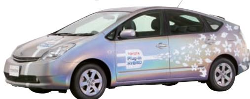
「トヨタプラグインHV」はHV技術をベースに、モーターのみでの走行可能距離を拡大、家庭用電源からの充電も可能な機能を備えている。これにより、燃費向上によるCO<sub>2</sub>排出量の削減や化石燃料の消費抑制、大気汚染防止に加え、燃料代における経済的な効果も期待できます。
