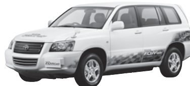
「トヨタFCHV-adv」は、搭載する燃料電池システムを一新し、マイナス30℃の低温下でも始動・走行が可能となった。また、システム補機の消費電力低減や再生ブレーキシステムの改善により燃費を約25%向上させた。さらに70MPaの高圧水素タンクを搭載することで、一回の充填による航続距離を約830kmへと向上させました。
