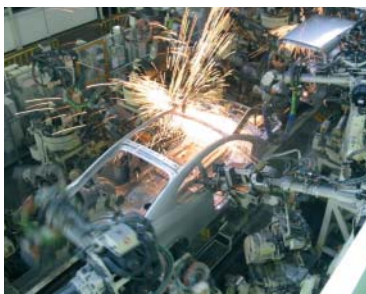
溶接ロボット
