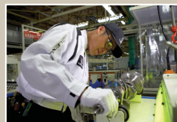
クランクシャフトの鏡面仕上げの検査
