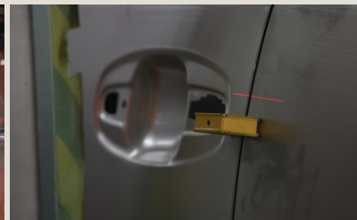
インライン計測(赤外線レーザーで計測)
