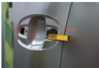
赤外線レーザーによるインライン計測
