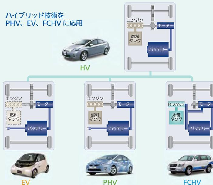
当社のハイブリッドシステムは、化石燃料はもちろん水素、バイオ燃料、電気まで応用可能な技術です。ハイブリッドに、外部から充電できる機能を追加して、電気エネルギーも利用できるようにしたものが、プラグインハイブリッド車（PHV）であり、電気自動車（EV）は、PHV車から、エンジンと燃料タンクを取り去ったものといえます。さらに、ハイブリッドのエンジンを燃料電池に置き換えれば燃料電池車（FCHV）となります。
