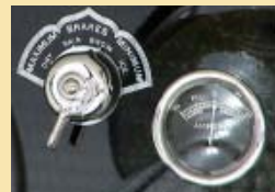
ブレーキの制動力調節レバー レバー先端を「DRY、RAIN、SNOW、ICE」の文字に合わせる。隣のメーターは電流計。
