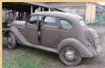
フロントフェンダー、ランニングボードは作り変えられており、ホイールとホイールキャップはノンオリジナル。
