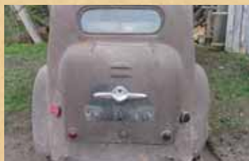
オリジナルでないもの:ベルトイントランク(AC型に付いた例はあったが、形状が異なる)、ボディに直付けされたテールランプ(オリジナルは独立タイプ)、トランク下部のボディパネル、リアバンパーが欠品
