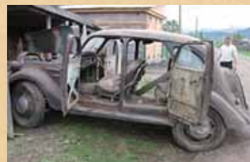
左フロントドアトリム無し、左リアドアガラス破損。
