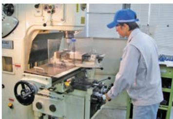
旋盤・フライス盤・研削盤等を使用して部品を切削・研削する技能や部品の組付技能を修得する専攻科です。実習ではエンジン部品や足廻り部品の穴あけ、面削り等を行っています。
