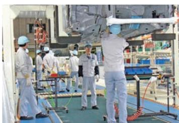
ボデーに計器盤やミッション・エンジン等を取り付ける組立技能を修得する専攻科です。組立工程には約 4,000 点の部品があり、車名、車型、グレード別に適合した部品を正確に取り付ける実習を行っています。
