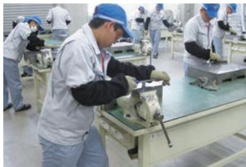
鍛造・プレス・樹脂成形に使用する金型の製作、修理の技能を修得する専攻科です。実習では型図面による型修理、エアグラインダー・ヤスリ等による研削等を行っています。
