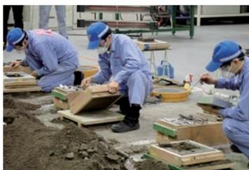
溶解した鉄・アルミニウムを型に流し込んで製品（鋳物）を作る技能を修得する専攻科です。実習では砂型鋳造法・金型鋳造法でエンジンや足廻りの素形材を造っています。
