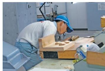
木材、樹脂等で自動車の模型や鋳造製品の型を製作する技能を修得する専攻科です。実習ではノミ、カンナ等の木工工具を使って美しく精密な製品を製作します。
