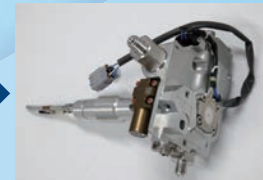
水素供給停止 (タンク遮断弁)
