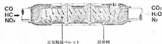
三元触媒コンバーター断面図
