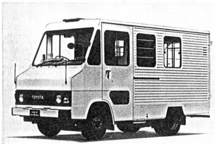
トヨエース クイックデリバリー B仕様：荷室 右サイドスライドドア付車 (N-BU60VH-QDFTFJ) '85.12 フェンダーポール、リヤウインドウワイパー、フロントティントガラス、スライド式ルーフセパレーター、 リヤサイドトリム（プリント合板）、荷くずれ防止バー、ローフック、リヤルーフヘッドライニングはオプション
