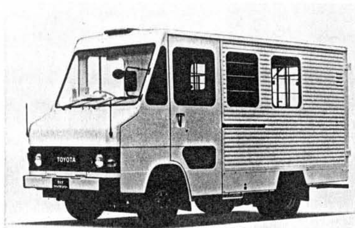
ダイナ クイックデリバリー B仕様：荷室 右サイドスライドドア付車 (N-BU60VH-QDFTF) '85.12 フェンダーポール、リヤウインドウワイパー、フロントティントガラス、スライド式ルーフセパレーター、 リヤサイドトリム（プリント合板）、荷くずれ防止バー、ローフック、リヤルーフヘッドライニングはオプション
