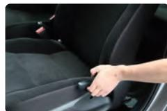
前席のみリクライニング可能。シンプルにシートの横にある手動レバーで操作する。後席と一体化はできないが、最大リクライニングは水平に近い
