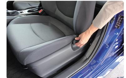
前席はシート横のレバーでリクライニングする。シート前方のバーでシート全体が前後に調整できる
