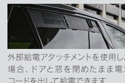
外部給電アタッチメントを使用した場合、ドアと窓を閉めたまま電源コードを出して給電できます
