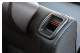
後席を前に倒す際は、背もたれの上にあるレバーを操作しながら、シートを前傾させる。ヘッドレストを外す必要もなく、そのまま動作可能
