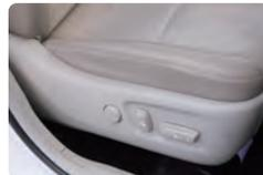
運転席のリクライニングは電動スイッチ。助手席のリクライニングは手動レバーだが、逆に操作はシンプル。後席の座面は前方へ可倒できるが、こちらもワンアクションで動作可能
