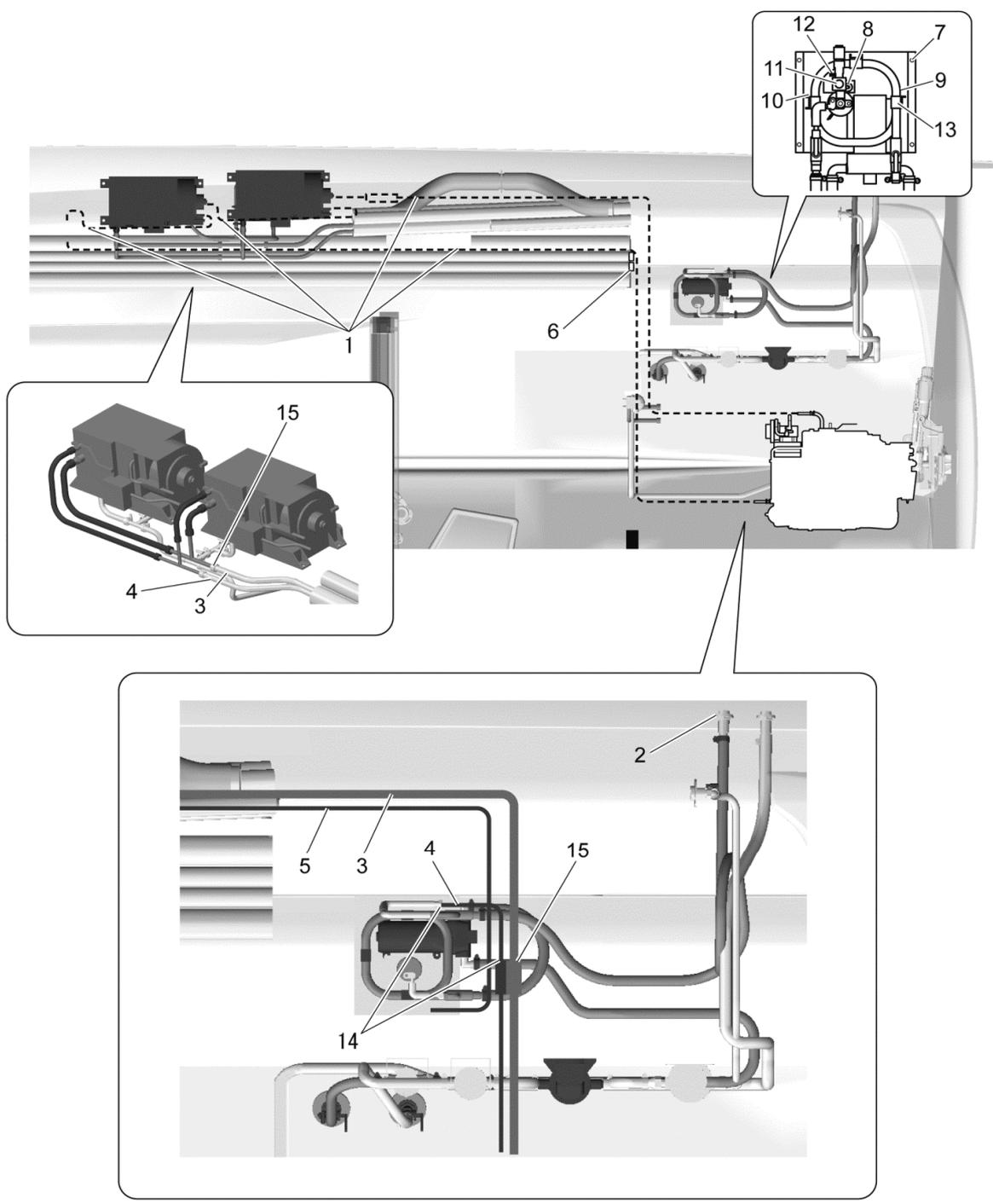
Fig. 22 バウスラスター・トヨタバーチャルアンカーシステム(オプション)
