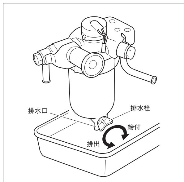
エンジン側はメーターディスプレイに「P2269 油水分離器異常」が表示された場合、次の手順で燃料・水分離器の排水作業を行ってください。
