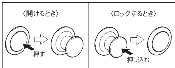
各キャビネットのハッチにはロックノブが付いています。ロックノブの中央部を押すとノブが飛び出でロックが解除され、ハッチを開くことができます。
