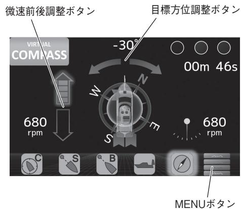
⑦ TVAS ディスプレイの「微速前後調整」ボタンを押すことで船の前後方向に船を進めることができ、流れる速度を調整することができます。
