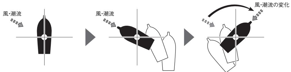
●バーチャルアンカーモードS：船尾を潮流、風向きの合力に逆らって目標位置を保持します。
