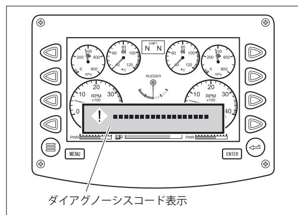
マルチディスプレイメーターにダイアグノーシスコード表示された場合、故障警報パネルのランプが点灯し、ブザーが鳴ります。
