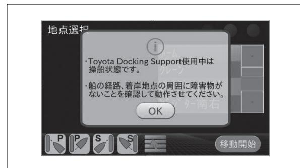
⑨ OK ボタンを押すと、着岸地点選択画面に移行します。着岸地点をリストから選択できます。リストは現在地から着岸地点までの距離が短い順に表示されます。
