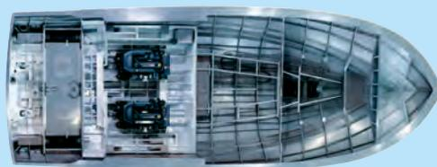
PONAM に採用しているアルミハルは、数あるアルミの中でも特に高い強度を誇るものだ。FRP に比べて衝撃が分散されやすく、振動を素早く減らすことで快適な乗り心地を生み出している。
