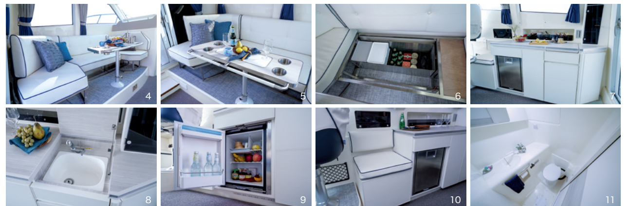
4. 低めにデザインされたソファは抜群の座り心地で、フレームにはステンレス枠を採用。5. モダンなデザインのテーブルはハンドルルーステンレス製のカップホルダーを設置。6. ソファ下には幅87cm、奥行き29cm、高さ24cmのステンレス製収納ボックスを2箇所設置。7. ギャレーは広めのカウンタートップで、収納ボックスの表面はレザー調で仕上げています。8. 開閉式天板を採用したシンクは通常は大型のカウンターとして使用できる。9. ギャレー左下の冷蔵庫は容量が40Lあり、機能性もかなり高い。10. ギャレー左側にはシングルベンチシートを設置。休憩時や歓談のシーンに重宝できそうです。11. 電動マリントイレを設置したパウダールームは高さ175cm、幅105cm、奥行き126cmと着替えにも十分なスペースが確保されている。
