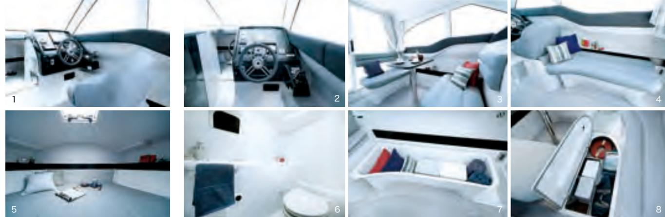
1. ヘルムステーションをウィンドウに近い位置に配置することで、視認性は抜群に良い。2. 広いコックピットパネルには10.4インチのGPS魚探が配置できるスペースも確保されている。3. 対面シート&テーブルを設置。歓談場所としてはもちろん、空調が効いた船内で釣りの仕掛けをセットする際にも活用できる。4. ベンチソファも配置することで、リラックスしてキャビンで寛ぐことができる。5. パウバースも広く、大人が横になって寛ぐこともできる。収納スペースも豊富で、クッション下には2箇所収納ボックスを設置している。6. レストルームには洗面化粧台と電動マリントイレを設置。着替えのできる広さも確保している。7. 対面シートとベンチソファの下には収納スペースを確保している。高さもしっかりと確保されており、使い勝手も良さそうだ。8. 床下に設置された収納ボックスはロッドなどの長尺物も収納可能な大容量の収納スペースとなっている。
