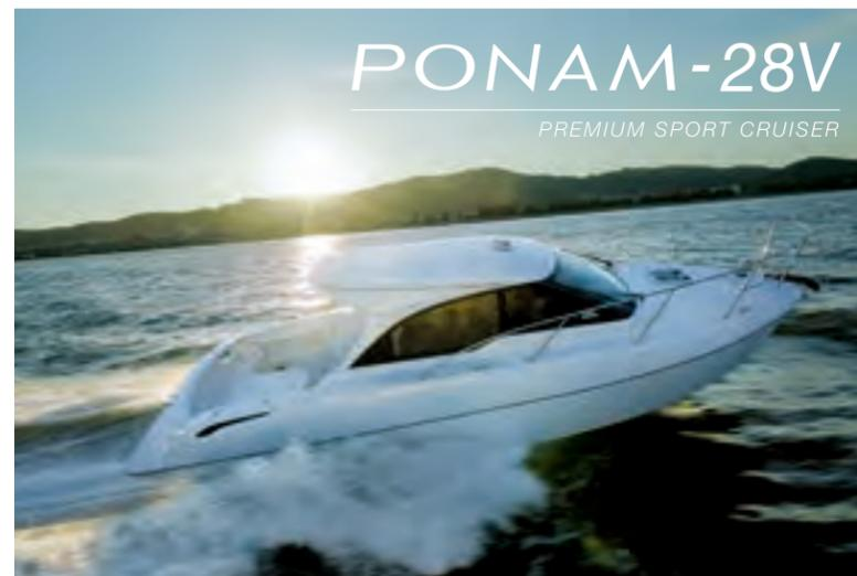
PONAM-28VはFRP、アルミ材、カーボン繊維の3種類をバランス良く使用したトヨタハイブリッドハルを採用し、従来のアルミハルに比べ、同等以上の剛性感と凌波性を実現するだけでなく、船体重量の軽量化にも成功している。そして、1基掛けエンジンでは世界初となる1軸TVASにおいては新たに作動中の充電機能を追加しており、使用時間が従来の約2倍に延長されたことで、これまで以上に長時間のフィッシングにも対応可能となった。船体のデザインはカーデザインで採用される複雑な3D曲面により、立体的なフォルムと曲線美を追求し、美しいデザインを実現。他にも、キャビン内には自動車で培った技術を応用した業界最高レベルの除湿機能付きマリンエアコンを搭載している。
