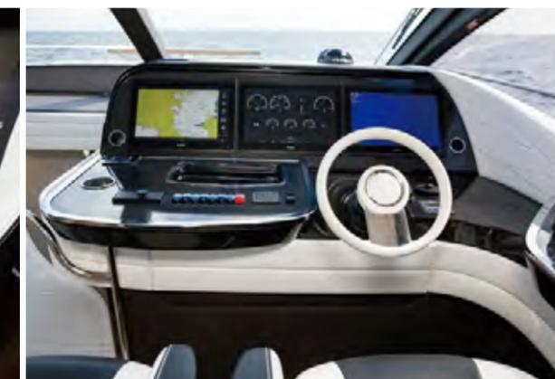
サロン前方、ヘルムステーションには2脚のLEXUSオリジナルパイロットシート。カーボン製のコンソールには、革巻きのホワイトハンドルと17インチマルチディスプレイが3台並ぶ。長時間でも疲れないドライビングポジションはカーライク。窓側にはスロットルレバーとジョイスティックが操作しやすいポジションに配置されている。コンソールは低めに抑えられ、ヘルムシートからの視界も良好。
