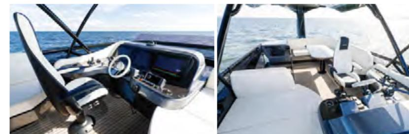
65フィートクラスの中ではコンパクトなフライブリッジは、スポーティーでスタイリッシュな、クーペスタイルを残したデザイン。フライブリッジ上部にカーボン(CFRP)を使い、軽量かつ高剛性な構造に造ることで、低重心で高い航行性能と快適な乗り心地を実現した。
