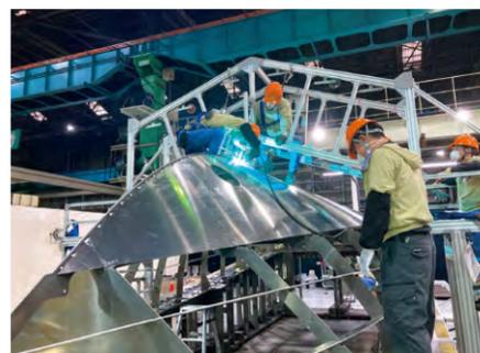
船外溶接作業の様子。溶接の際には高所作業用の機材も使用している。
