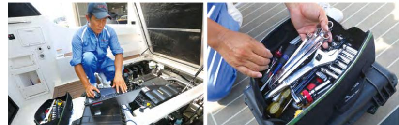
エンジンの状況を正確に把握するため、パソコンとエンジンを繋ぎ、様々な項目で異常値が検出されないかを点検している。普段から使用する工具類は丁寧にメンテナンスし、専用の工具バッグに収納している。
