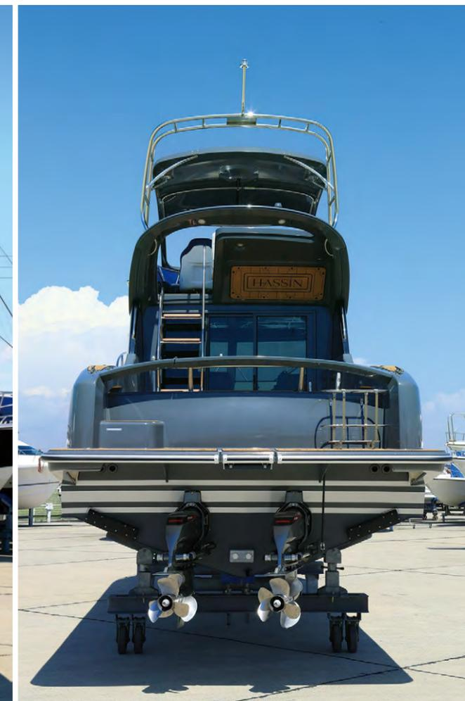
船底部分と一部ラッピングできない箇所は塗装を行なっているが、ラッピングシートと同様の見た目になるよう塗料を調色しており、違和感を感じない。
