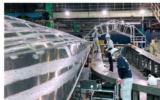
アルミハルの凹凸を測定できる機材を使用し、カメラでアルミハルをスキャンし、凹凸の有無を確認している。凹凸がある場合は画面上にグラデーションで表示される。
