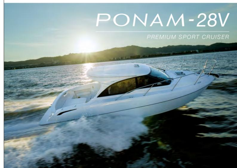
PONAM-28VはFRP、アルミ材、カーボン繊維の3種類をバランス良く使用したトヨタハイブリッドハルを採用し、従来のアルミハルに比べ、同等以上の剛性感と凌波性を実現するだけでなく、船体重量の軽量化にも成功している。そして、1基掛けエンジンでは世界初となる1軸TVASにおいては新たに作動中の充電機能を追加しており、使用時間が従来の約2倍に延長されたことで、これまで以上に長時間のフィッシングにも対応可能となった。船体のデザインはカーデザインで採用される複雑な3D曲面により、立体的なフォルムと曲線美を追求し、美しいデザインを実現。他にも、キャビン内には自動車で培った技術を応用した業界最高レベルの除湿機能付きマリンエアコンを搭載している。
