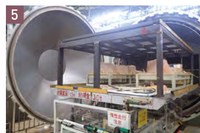
5 オートクレープ内で熱と圧力をかけて成形されたパネルを取り出す様子。
