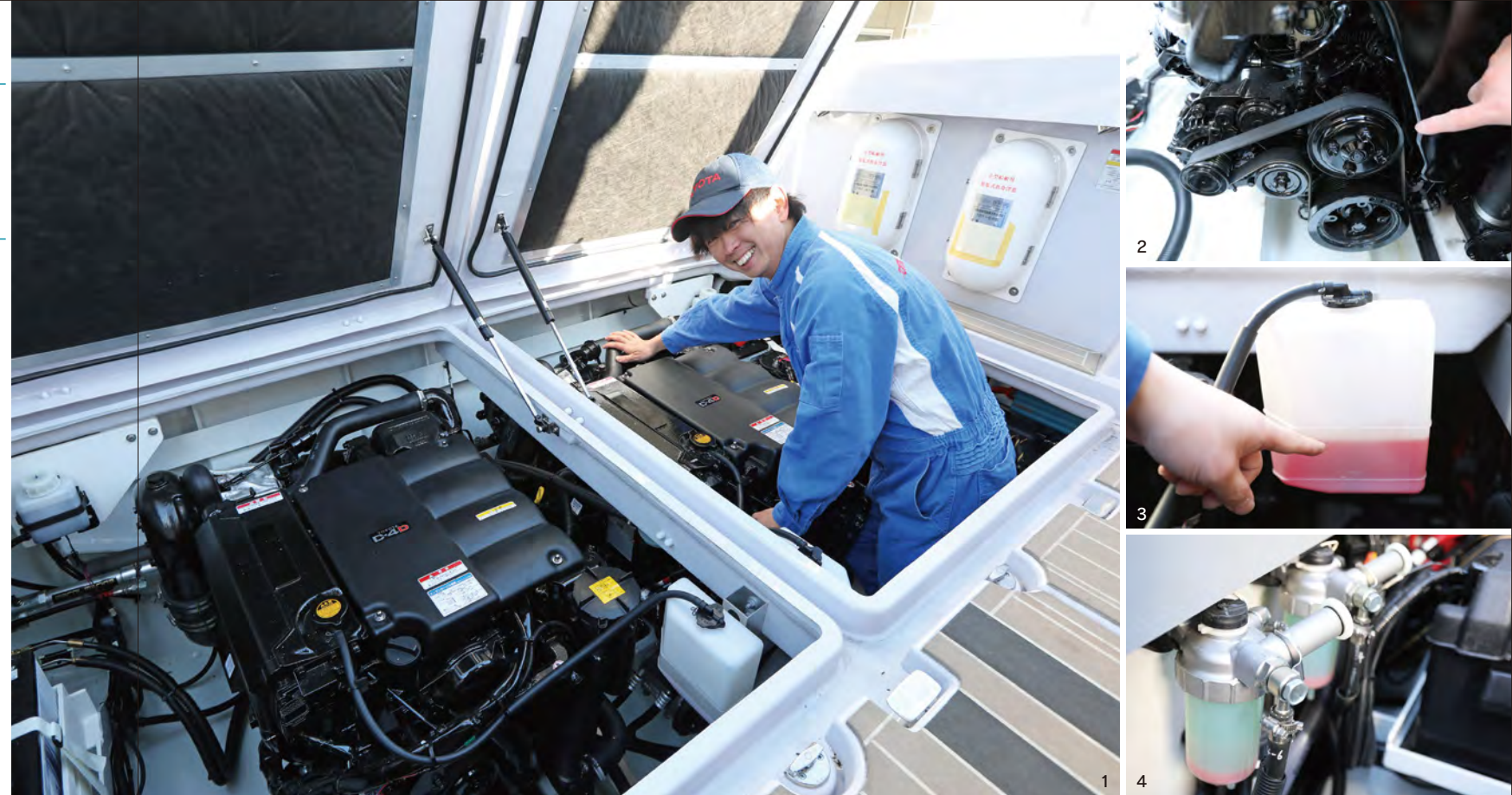
1. 今回のインタビューでは日頃からオーナーができるメンテナンスポイントについて、分かりやすく伝えてくれた。2. エンジン始動前にVベルトのたわみ、摩耗、亀裂などをチェックしておく。3. 冷却水のリザーブタンクも目視で大きく減っていないか確認しておく。4. 油水分離器は水が混入していないか確認しておく。
