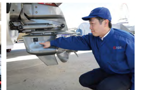
帰港後はドライブの水洗をしっかりと行うことで、ドライブ・エンジン内を塩害から防いでくれる。
