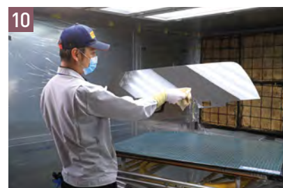
10 最終製品をライトの反射を利用してきめ細かく検査。この後、梱包の工程へ。
