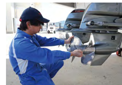
乗船前にはプロペラの取り付け具合に歪みや違和感が無いか確認する。
