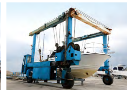
大型25t自走式クレーン。大切なボートをスムーズかつ安全に揚降してくれる。
