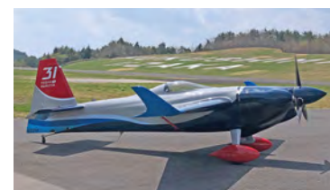
エアレースで活躍する室屋義秀選手の機体（エンジンカウル部分）にもトヨタ製のカーボンパーツが採用されている。
