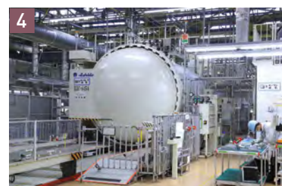
4 金型とカーボン材をオートクレープに投入した状態。
