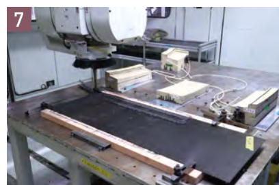
7 5軸加工機で事前に設定された形状にカーボンを切り出す。
