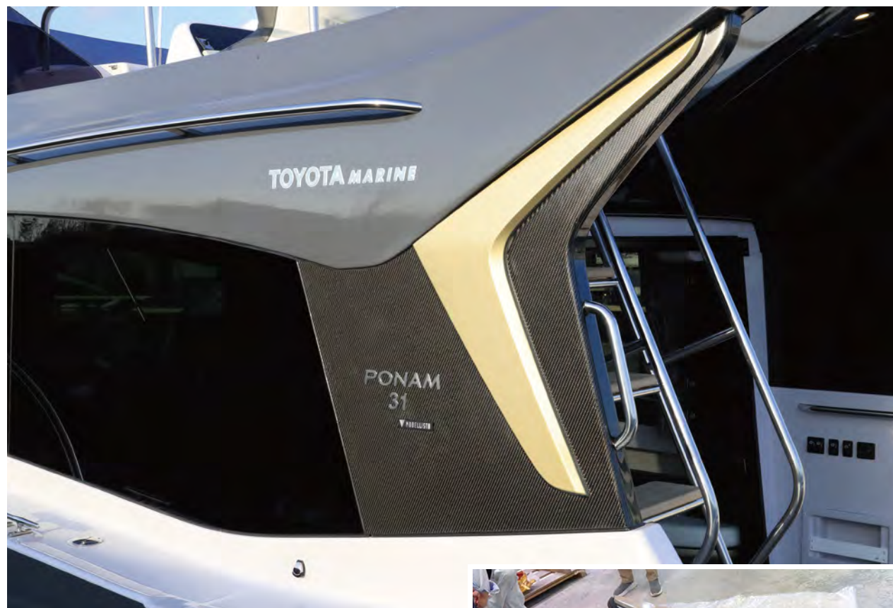
開発技術が採用されたPONAM-31 Z Gradeのリアガーニッシュ。リアルカーボンの質感と織目の美しさが際立つ。
