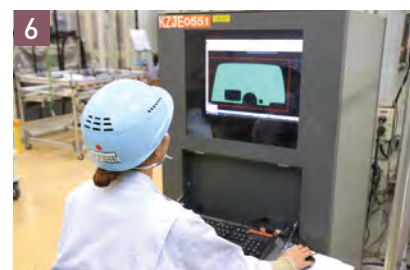
6 5軸加工機の操作モニターにより、切り出す形状を再確認。
