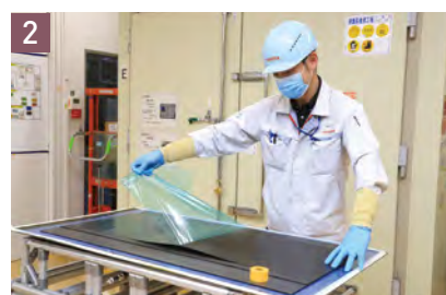
2 同じサイズに切断されたカーボン材を何層も重ねていく。
