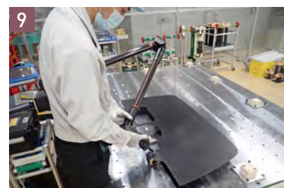
9 専用の機械を使用し、形状や強度を徹底的にチェックする。
