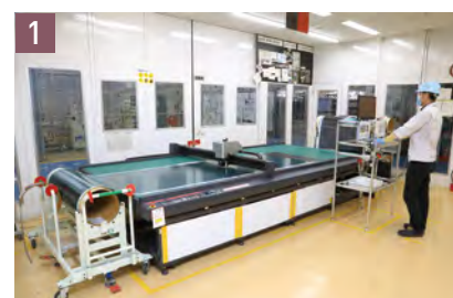
1 カarbon材をカットマシンで規定形状に切断する。
