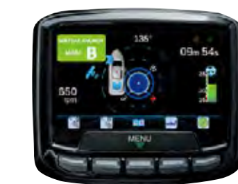
1軸TVAS(トヨタバーチャルアンカーシステム)
