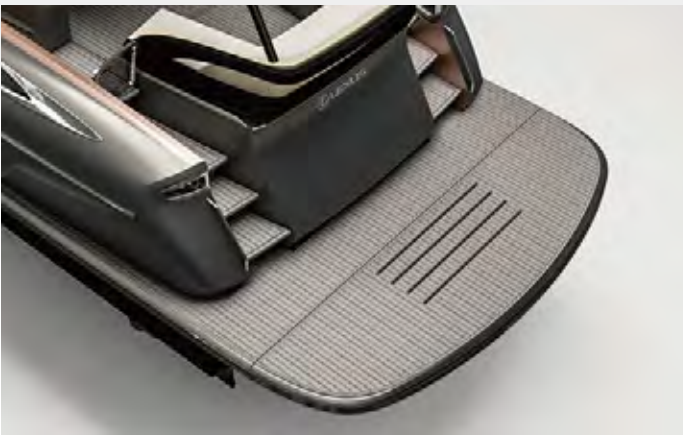
スイミングプラットフォームは約700mm延長し、オフショアでの楽しみ方の幅を広げている。
