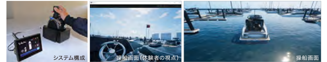
操船VRツール(システム構成、実際の画面、体感)
