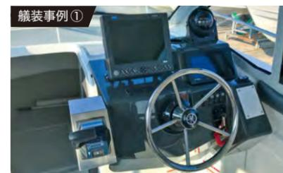
小型船舶操縦士教習で使用する為、オリジナルボックスを作成し、スロットルリモコンを左側に変更している。
