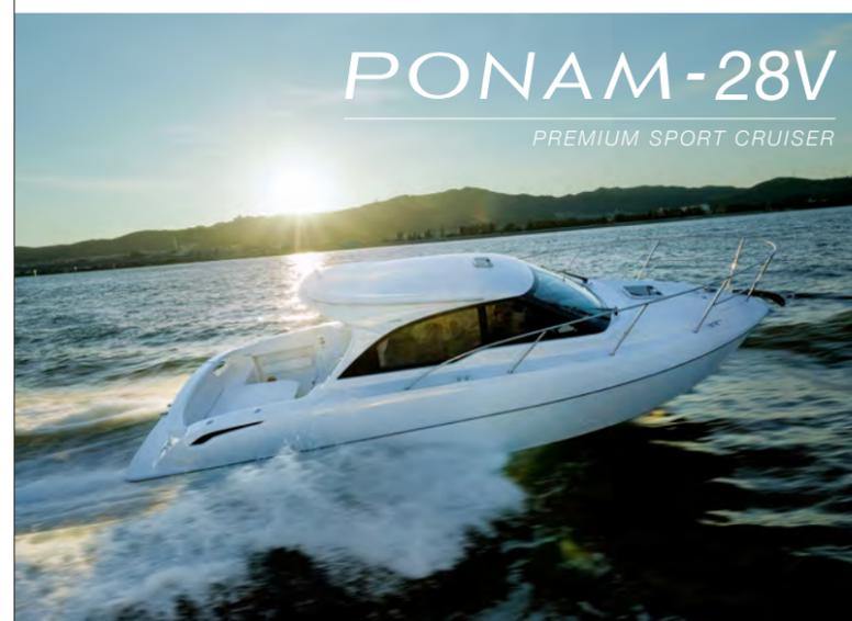
PONAM-28VはFRP、アルミ材、カーボン繊維の3種類をバランス良く使用したトヨタハイブリッドハルを採用し、従来のアルミハルに比べ、同等以上の剛性感と凌波性を実現するだけでなく、船体重量の軽量化にも成功している。さらに、1基掛けエンジンでは世界初となる1軸TVASには作動中の充電機能を追加しており、使用時間が従来の約2倍に延長されたことで、これまで以上に長時間のフィッシングにも対応可能となった。船体のデザインはカーデザインで採用される複雑な3D曲面により、立体的なフォルムと曲線美を追求し、美しいデザインを実現。他にも、キャビン内には自動車で培った技術に応用した業界最高レベルの除湿機能付きマリンエアコンを搭載している。
