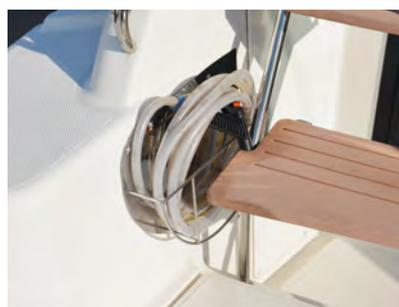
オーナーのアイデアあふれる収納。お盆を保管するための器具を利用したホース収納(写真左)と、階段裏のデッドスペースを利用したロープ収納袋(写真右)。
