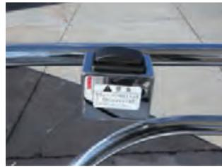
ステンレスフレームに付けられている開閉スイッチ。モーターとともに、本体に装着されたパワーユニットは、DC電源を繋ぐだけで作動させる事ができる。
