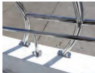
FRP製の電動ルーフを固定するために、3次元の捻れをつけたフレーム構造を船体に自立させ、高い強度を持たせている。
