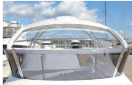
美しい曲線を描くFRP製ルーフとステンレスフレーム。最小のピラーにより、フロントウィンドウとサイドウィンドウをできる限り広くとる開放的なデザインがトマオーニングの特徴。
