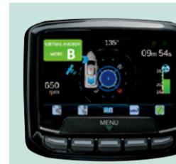
PONAM-28Vに搭載された1軸TVAS。操作も簡単で、ボタン一つで船体の位置をコントロールできる優れものだ。
