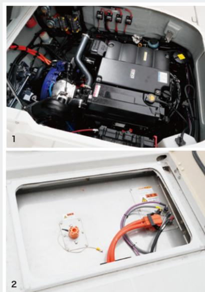
1.エンジンは市販艇と同じM1KD-VH。ドライブとの間に油圧クラッチ付きのモーター・ジェネレーター（青い部分）を搭載している。 2.従来モデルのイキスペースにはLiイオンバッテリーを搭載している。
