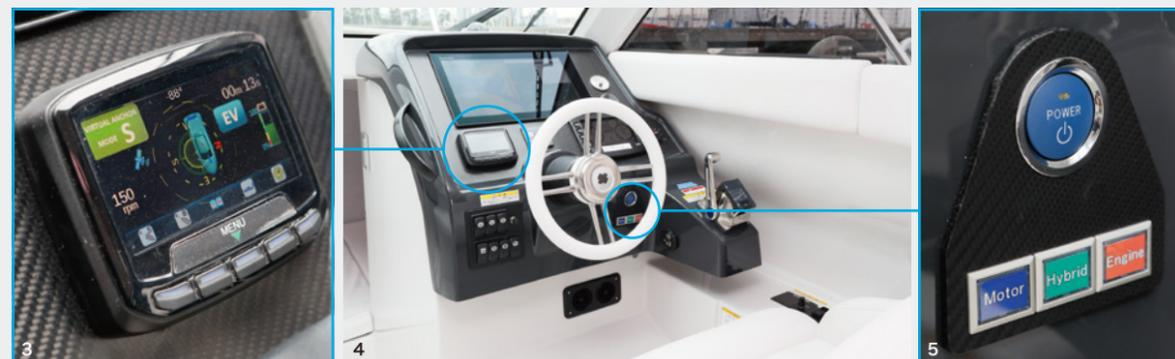
3.抜群の静粛性を実現したオール電動1軸TVASを操作するコントローラー。 4.ヘルムステーションも市販モデルと比較しても見た目には大きな違いはない。 5.スタートボタンはプリウスと同じものが採用されており、トヨタの遊び心を感じる。下には駆動モードを変更するスイッチが設けられている。
