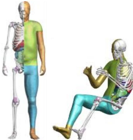
トヨタの THUMS(サムス : Total Human Model for Safety)は、クルマの衝突事故における人体への傷害を解析する先進的なコンピューター上のシミュレーションモデルです。20年にわたる改良を経て、トヨタのクルマの衝突安全性能向上に不可欠な技術として確立され、国内・海外の研究者や技術者にも活用されています。衝突シミュレーションでは実車を用いた衝突試験のようにモノを作って壊して捨てることはないため、環境にやさしい技術とも言えます。この THUMS を今後自動車産業全体で幅広くクルマの安全性向上に役立てていただきたいとの思いから、2021年1月より無償で公開しています。THUMS をより多くの企業や研究機関でご活用いただくことで、すべての人に安全な移動手段を提供し、交通事故死傷者ゼロの社会の実現を目指す仲間づくりを広げていきたいと考えています。
